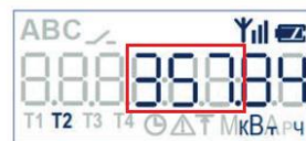
Рисунок 3. Пример отображения показаний электроэнергии на ЖКИ
