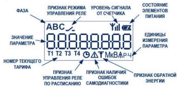
Рисунок 2. Вид ЖКИ Пульта МИР и назначение отображаемых символов
